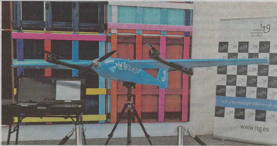
El Zarek V2 puede despegar y aterrizar en horizontal y volar a 100 kilómetros por hora. VERÓNICA VÁZQUEZ
